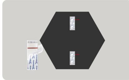
Tenez le gabarit contre le mur et placez les bandelettes dans les encoches. Appuyez pendant 5 secondes sur chaque morceau de bande adhésive. **Ne frottez pas.**
